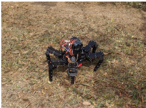
Figura 24. Movimiento del robot hexápodo sobre una superficie irregular
