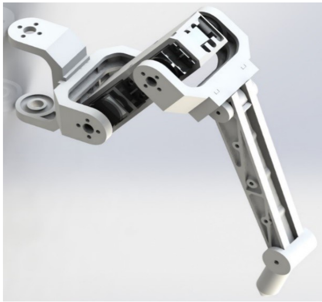
Figura 4. Vista renderizada de una extremidad del robot hexápodo Fuente: elaboración propia.
