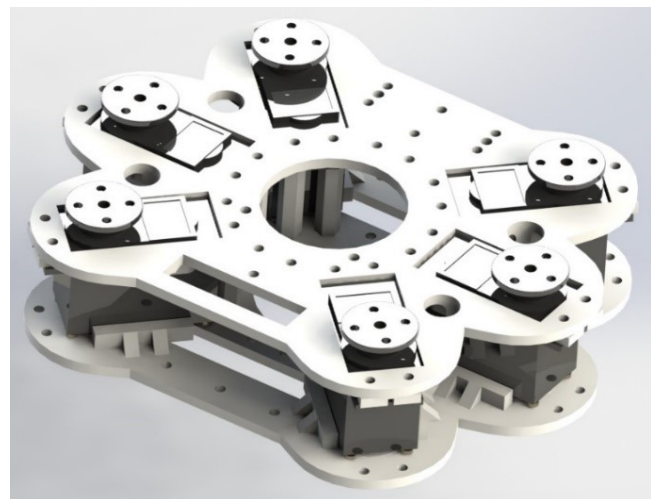
Figura 5. Vista renderizada del cuerpo central del robot hexápodo. Fuente: elaboración propia.
