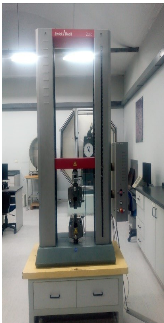
Figura 5. Máquina de ensayo universal ZwickRoell Z050 – Ensayo de tracción Fuente: elaboración propia.
