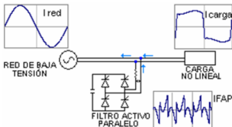
Figura 9. Principio de funcionamiento de un filtro activo.
