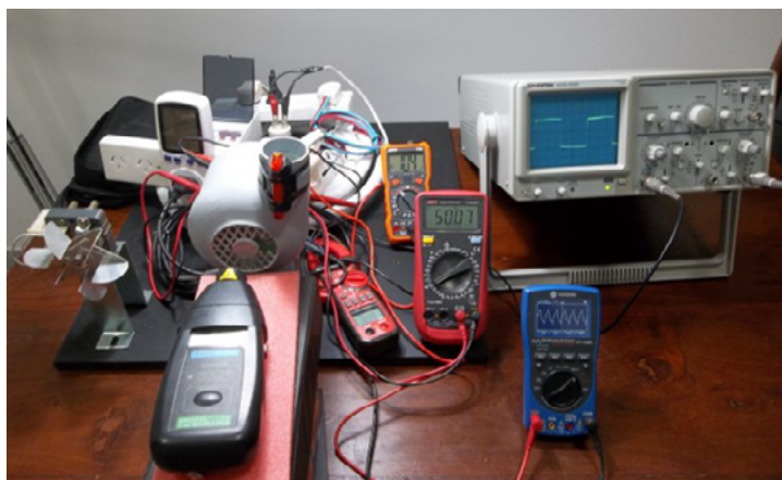
Figura 3 y 4. A la derecha, imagen del software Cfturbo 2020 R2.0, modelado 3D del eje Z. A la izquierda, banco de pruebas conectado al motor extractor/soplador centrífugo de aire viciado de SARS-CoV-2 o covid-19 (coronavirus) con multímetro digital (medidor de voltios en AC), pinza amperométrica (medidor de intensidad de la corriente en AC), frecuencímetro (medidor de hercios), fotocómetro láser (medidor de velocidad en RPM), osciloscopio digital medidor de la forma de onda de la corriente alterna en tensión ( V_{pico-pico} , V_{avg} , V_{rms} ), para cálculo de factor de cresta de distorsión armónica, osciloscopio analógico para observación cualitativa de la THD (distorsión armónica de la corriente alterna), vatímetro (medidor de potencia activa en vatios o watts), factor de potencia (coseno de \phi ), power-meter (medidor del consumo de energía activa en kilowatts-hora: kWh).
