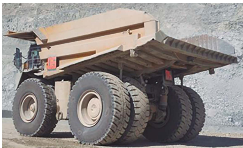
Figura 13. Alerón metálico en camión minero
