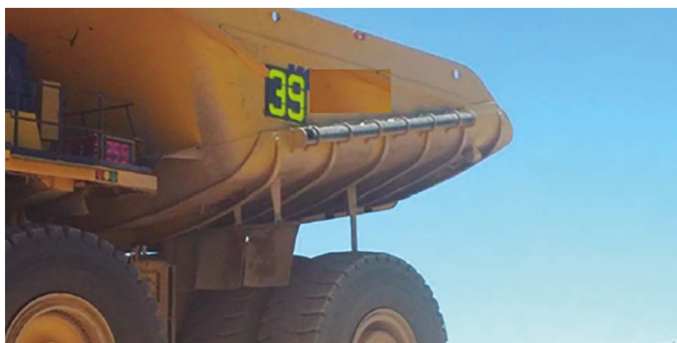
Figura 2. Camión con protector de tubo PVC
