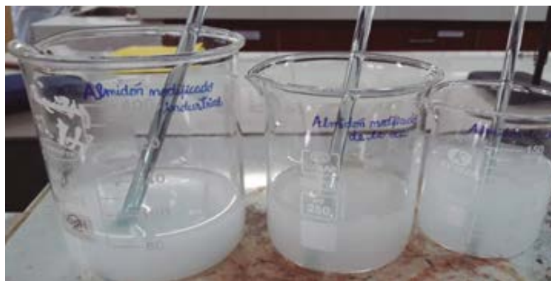
Figura 6. Determinación de la temperatura de gelificación en muestras de almidón
