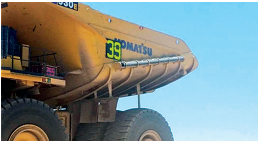
Figura 6. Tubería HDPE en parte lateral de camión. Fuente: [4]
