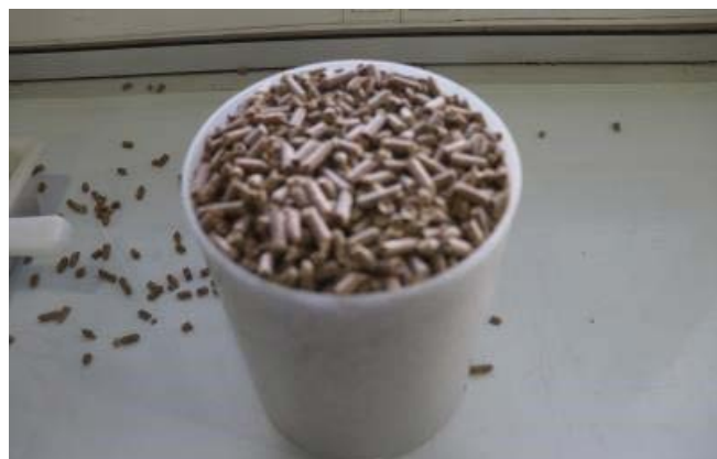
Figura 5. Vista del ensayo de densidad aparente de pellets, con recipiente normado
