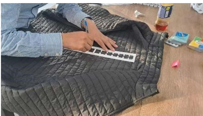
Figura 3. Posicionamiento del prototipo utilizando una plantilla para alinear correctamente las vértebras en su ubicación anatómica y colocación de piezas en una prenda
