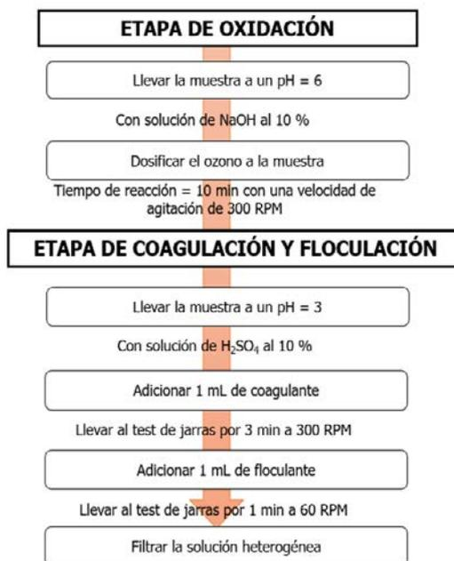
Figura 4. Diagramas de los métodos de tratamiento aplicados
