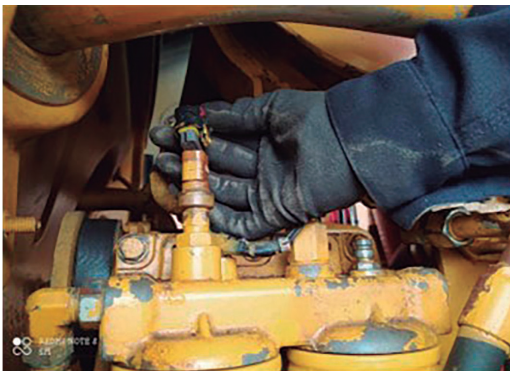
Figura 17. Desconexión del sensor de presión de combustible
