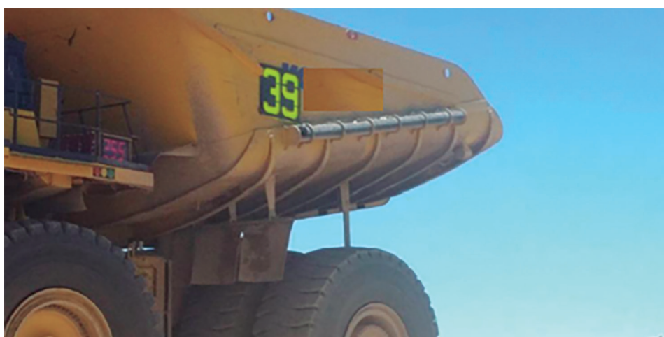
Figura 2. Camión con protector de tubo PVC
