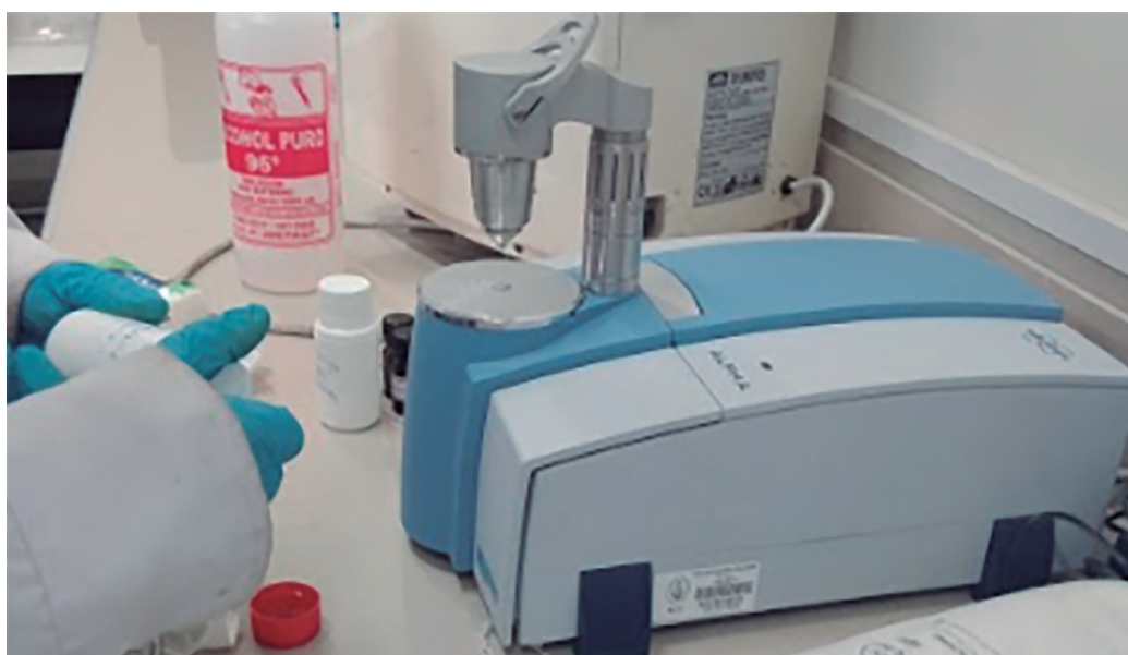
Figura 9. Realizando el ATR para el almidón con el espectrómetro Alpha en la UNI
