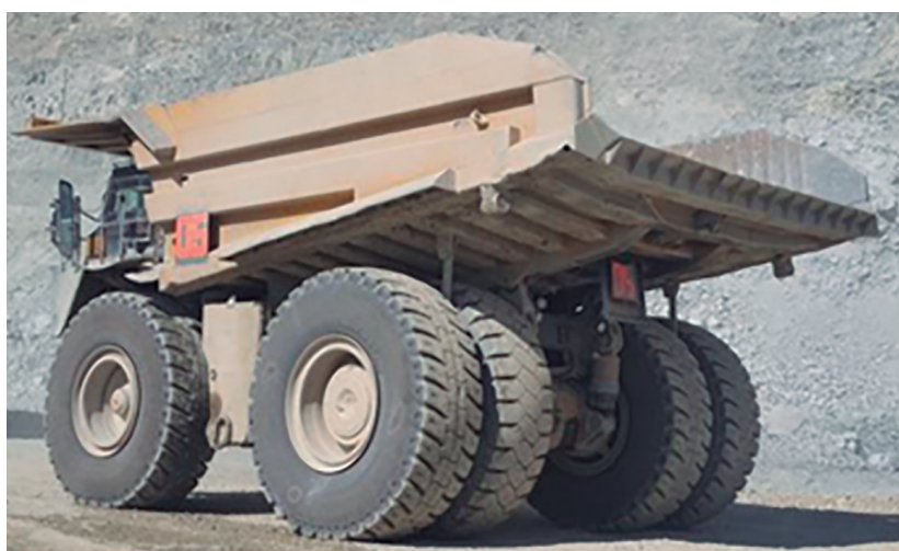
Figura 13. Alerón metálico en camión minero
