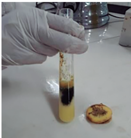
Figura 8. Reconocimiento de amilosa con solución de Lugol
