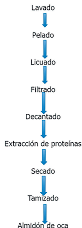
Figura 3. Esquema del proceso de extracción de almidón Fuente: Elaboración propia.
