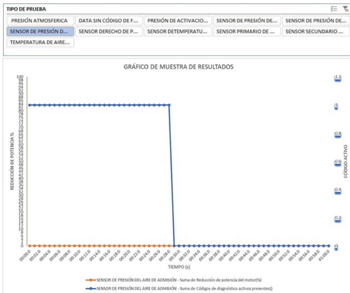
Figura 10. Gráfico de resultado de la reducción de la potencia del motor en la prueba de «desconexión sensorial» con desconexión del sensor de presión de aire de admisión
