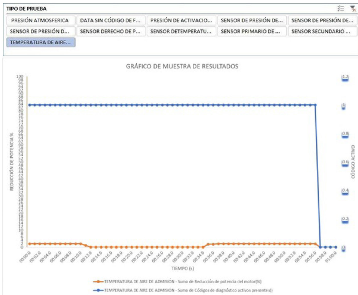
Figura 15. Gráfico de resultado de la reducción de la potencia del motor en la prueba de «desconexión sensorial» con desconexión del sensor de temperatura del aire de admisión
