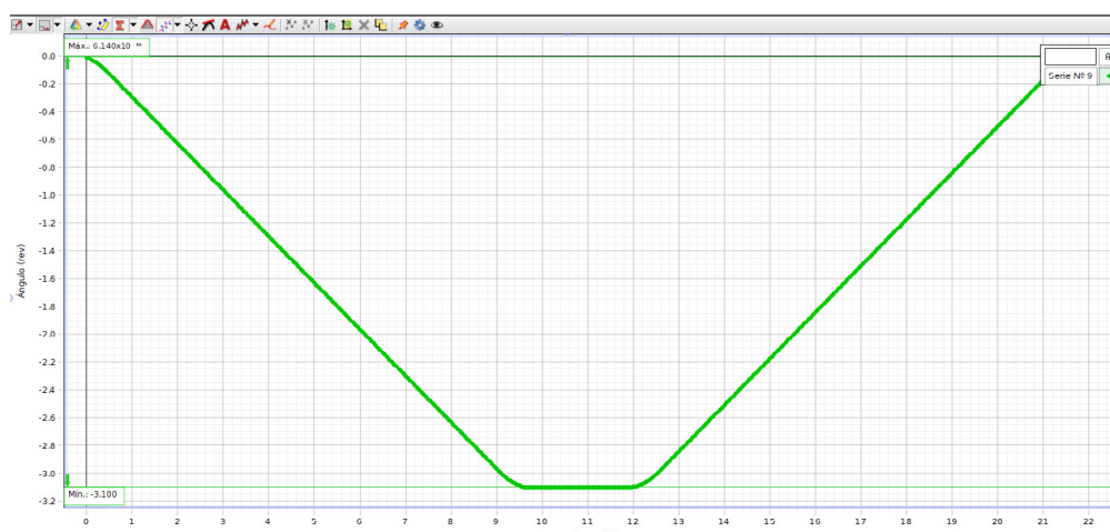
Figura 8. Variabilidad del ángulo de giro de la parte superior de la estructura
