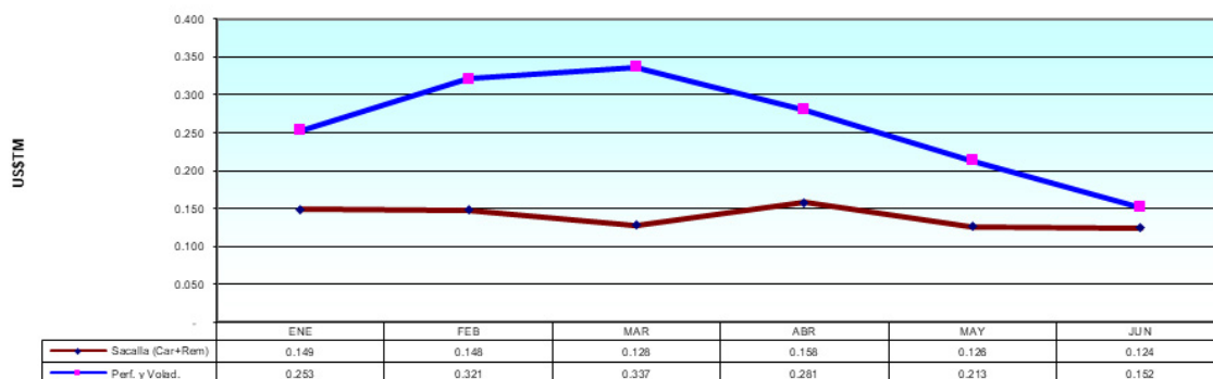
Figura 4. Costo de perforación y voladura vs. costo de carguío y remoción
