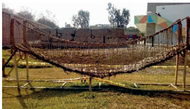
Figura 1. Puente colgante fabricado en ichu. Fuente: Elaboración propia.
