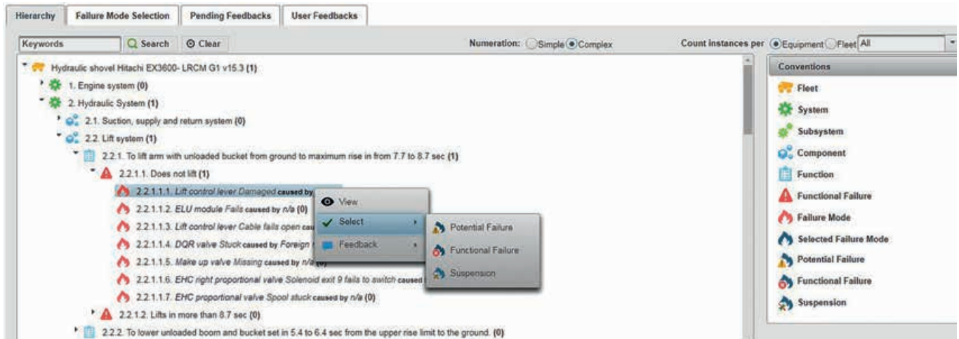
Figura 3. Definición de eventos de fin de modos de falla. Fuente: MESH software.
