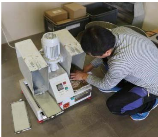
Figura 4. Vista del ensayo de la durabilidad mecánica de los pellets, con el durabilímetro marca Mabrick DBM 203
