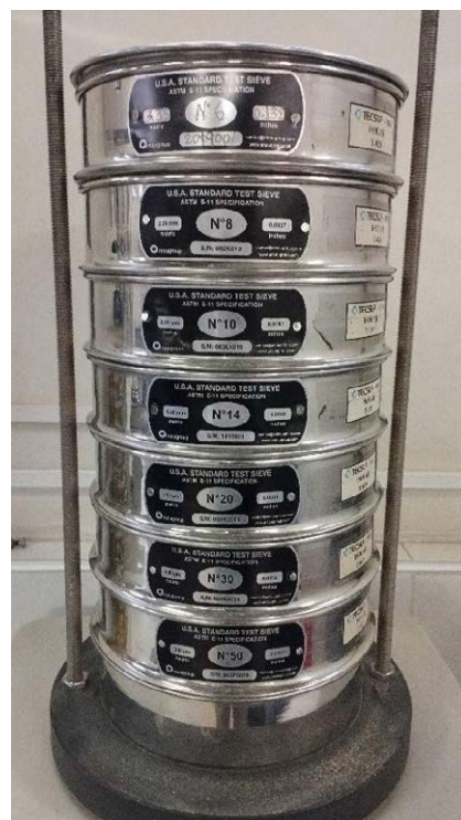
Figura 5. Set de mallas para clasificación de granulometrías finas
