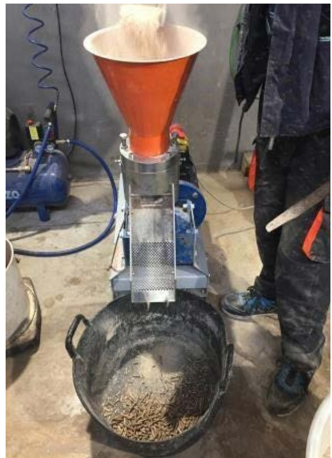
Figura 3. Vista del proceso de pelletizado de biomasa peruana con máquina de pelletizado de 2 HP, marca Ecofrío
