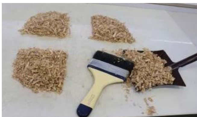
Figura 1. Vista del método de cono y cuarteo para reducción de masa de muestra
