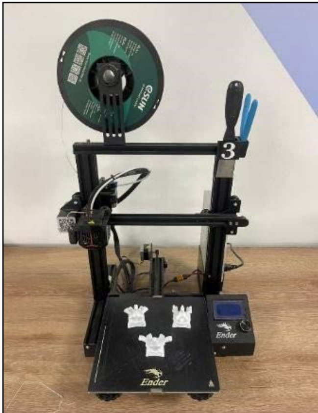
Figura 2. La impresora 3D Ender en proceso de impresión de modelos de vértebras visibles sobre la plataforma. El filamento, colocado en la parte superior de la máquina, está listo para alimentar la impresora
