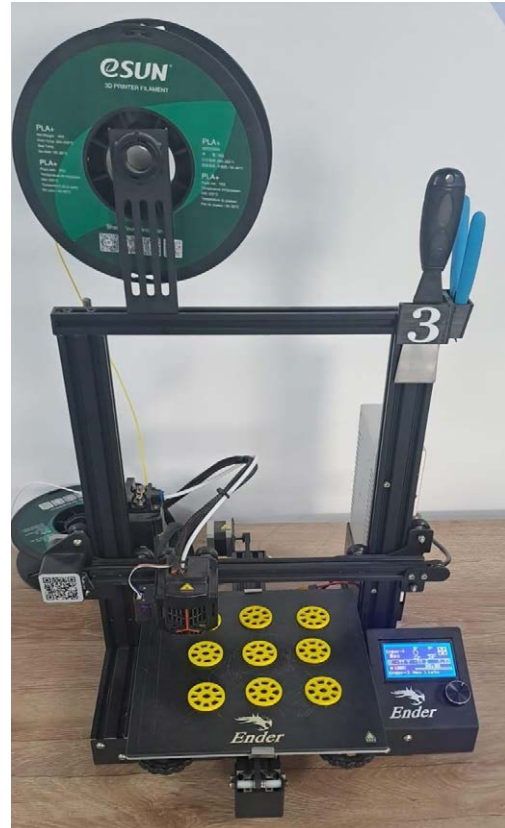
Figura 4. Impresora 3D Ender en proceso de fabricación de piezas de andamio a escala, utilizando filamento PLA de la marca eSUN
