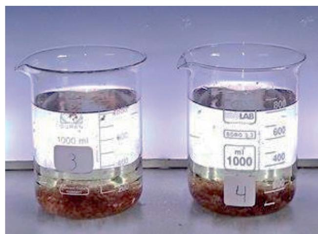
Figura 3. Resultado de la coagulación – floculación.
