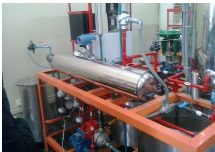
Figura 1. Intercambiador de calor. Fuente: Elaboración propia.
