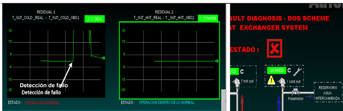
Figura 13. Detección e identificación de fallo en sensor de temperatura salida del flujo de agua fría. Izquierda: residual generado. Derecha: alarma en HMI sobre instrumento en fallo. Fuente: Elaboración propia.
