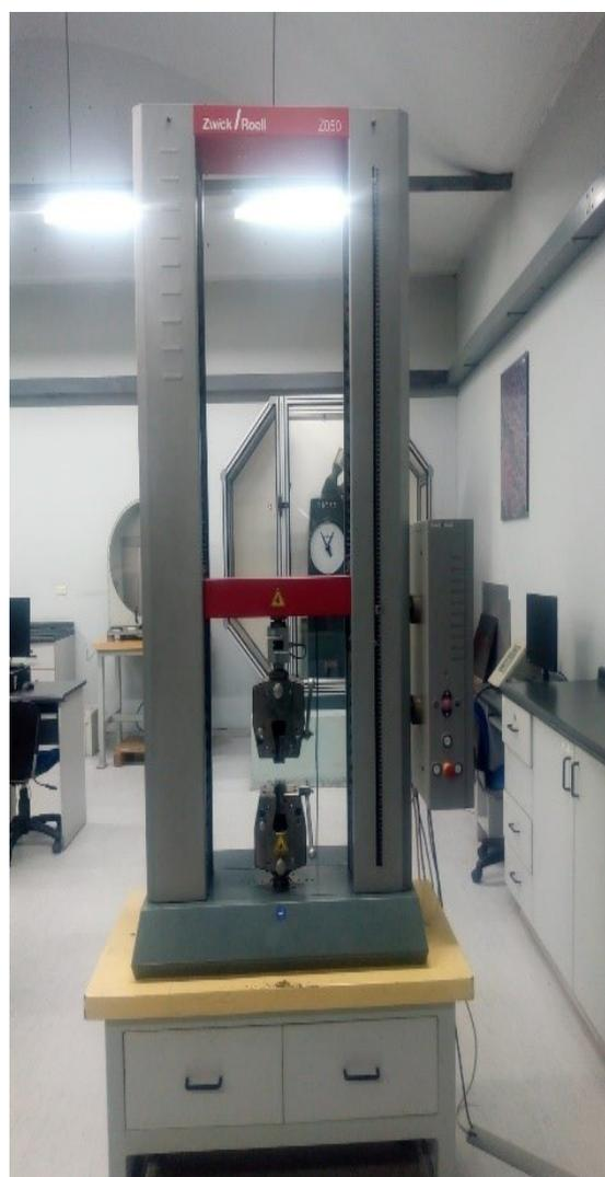
Figura 5. Máquina de ensayo universal ZwickRoell Z050 – Ensayo de tracción
