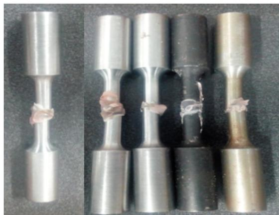
Figura 4. Probetas de tracción – uniones adhesivas con las resinas elaboradas
